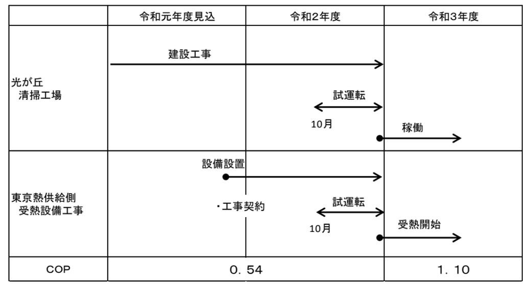
光が丘地域冷暖房 再構築ステップ工程案とエネルギー効率
